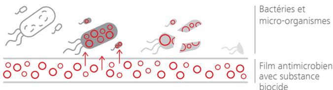
CleanCover agit en libérant des agents antibactériens sur la surface du film, infiltrant les micro-organismes et les neutralisant, sans aucun risque pour les utilisateurs.
